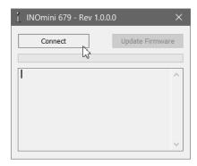
Cuando se complete la actualización, la ventana del bootloader - cargador de arranque aparecerá como se muestra en esta ilustración, y el INOmini 679 se reiniciará, regresando a cualquier menú que se mostrara antes de la actualización.
